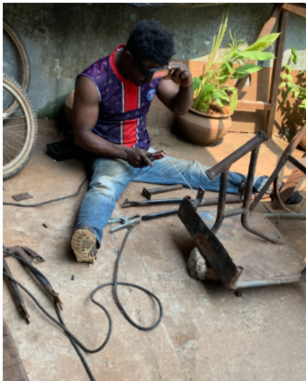
Reparaturschweissung an Spezialvelo
